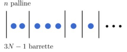
Figura 4.5: Una possibile organizzazione di n oggetti in 3N - 1 separatori. Questo vuol dire che stiamo dando 0 quanti energia al primo oscillatore, 2 quanti al secondo, 3 al terzo e così via.
