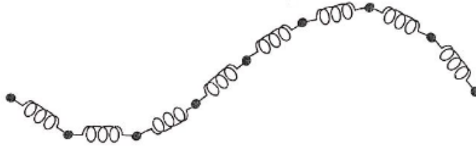
Figura 4.1: Sistema di masse m collegate tramite molle
