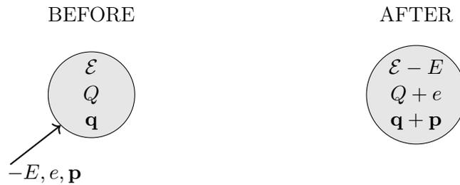
**Figura 6.10:** Rappresentazione assorbimento di un'antiparticella di energia  $-E$ , carica  $e$  e tri-impulso  $\mathbf{p}$ .
