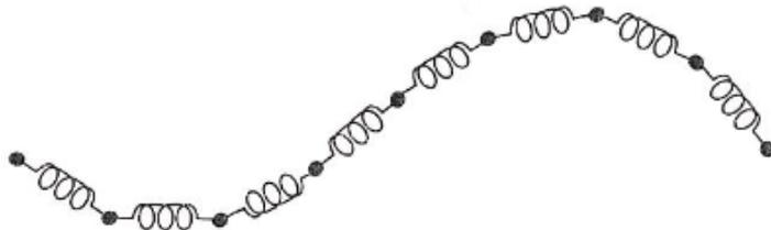
**Figura 6.1:** Sistema di masse  $m$  collegate tramite molle
