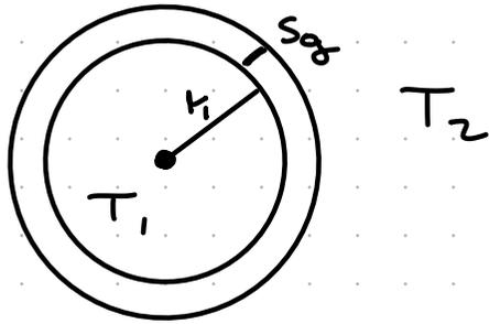
$k_g = 0.2 \text{ W/mK}$ ,  $T_1 = 50^\circ\text{C}$ ,  $T_2 = 10^\circ\text{C}$ ,  $s_g = 2 \text{ cm}$ ,  $1 \text{ cm}$
