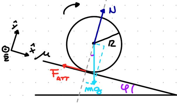
DETERMINA : •  $\varphi$  T.C. PURO ROTOLAMENTO
